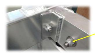
Écrous d'aluminium pour éviter le blocage des boulons lors de vos ajustements futurs.
