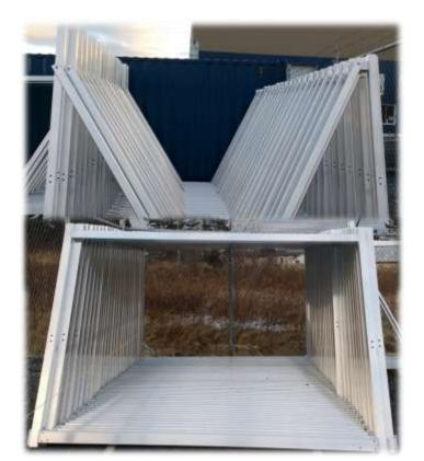
Cadre en V et Rectangle Soudés pour une meilleure rigidité et facilite l'assemblage.
