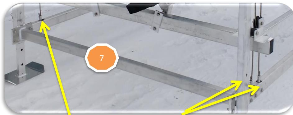
Entrer les 3 boucles du cadre levé: 1 du côté cadre rectangle et 2 dans le cadre en V(coté treuil) et à l'aide de 3 boulons 3/8 x 2 1/2 écrous et rondelles) **Photo 7**
