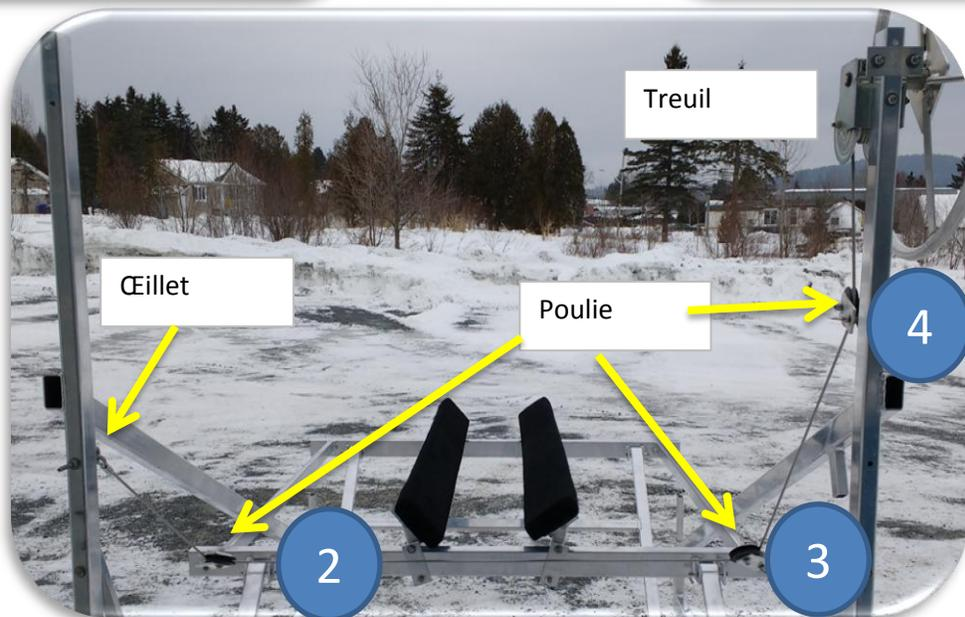
Installation du treuil à gauche. Installer le câble avec l'œillet dans le mat opposé du treuil et le passer dans les poulies 2,3 et 4.
