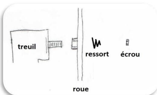
Installer la roue. Mettre du frein à filet (locktite) sur le boulon. Tourner la roue dans le sens horaire et enrouler le Câble en tenant fermement avec un gant pour l'enroulement égal sur le baril du treuil
