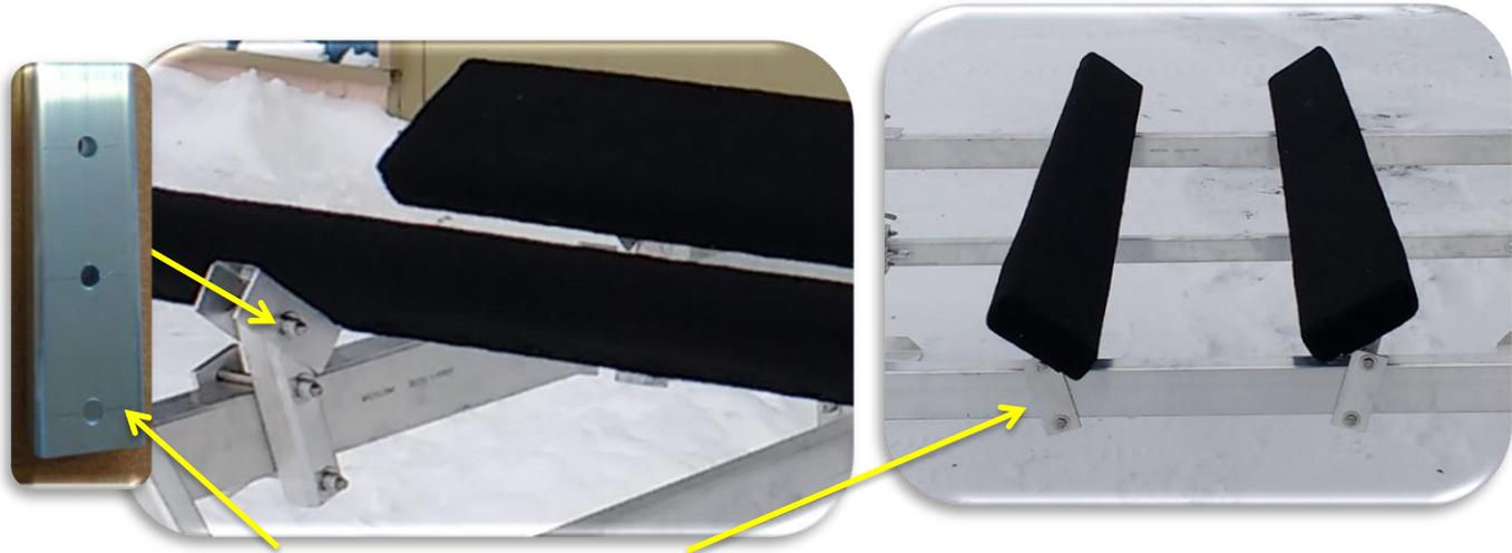
Installer à égale distance les 4 tubes avec trous, 4 petites plaques à 2 trous 8 boulons 3/8 x 4 1/2, rondelles et écrous aluminium ensuite fixer les tapis (8 boulon carrosserie 5/16 x 2 1/2)
